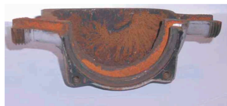
Ausfall einer Heizungspumpe aufgrund Steinbildung
